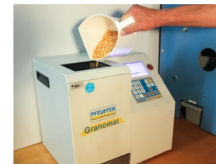
Granomat bei der Bestimmung von Schüttdichte und Feuchtigkeit einer Maispartie
