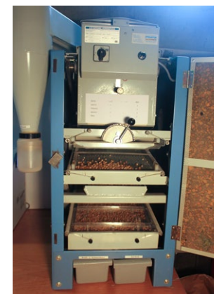
Über die verschiedenen sich bewegenden Siebe des Probenreinigers wird die Qualität der Maispartie überprüft.
